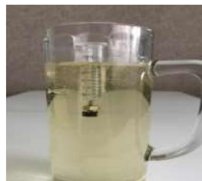
Каждый раз отмечаем на шприце на сколько погружается ареометр.
